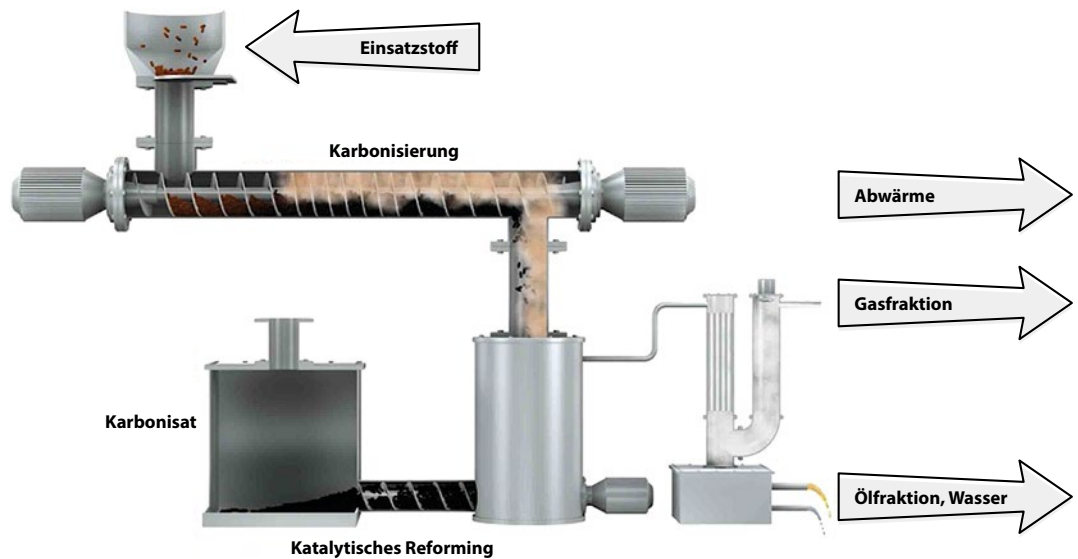
Abbildung 1: Verfahrensstufen der TCR®-Pyrolyse
